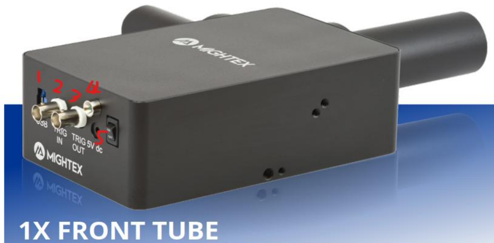
图 1-2 DMD 投影仪（MIGHTEX）实物及主要接口截图（要替换）
